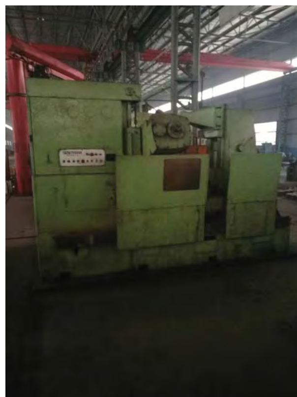
图 2-24 减速机齿轮及齿轮轴工艺的数控车床 图 2-25 减速机齿轮及齿轮轴工艺滚齿成型（滚齿机）
