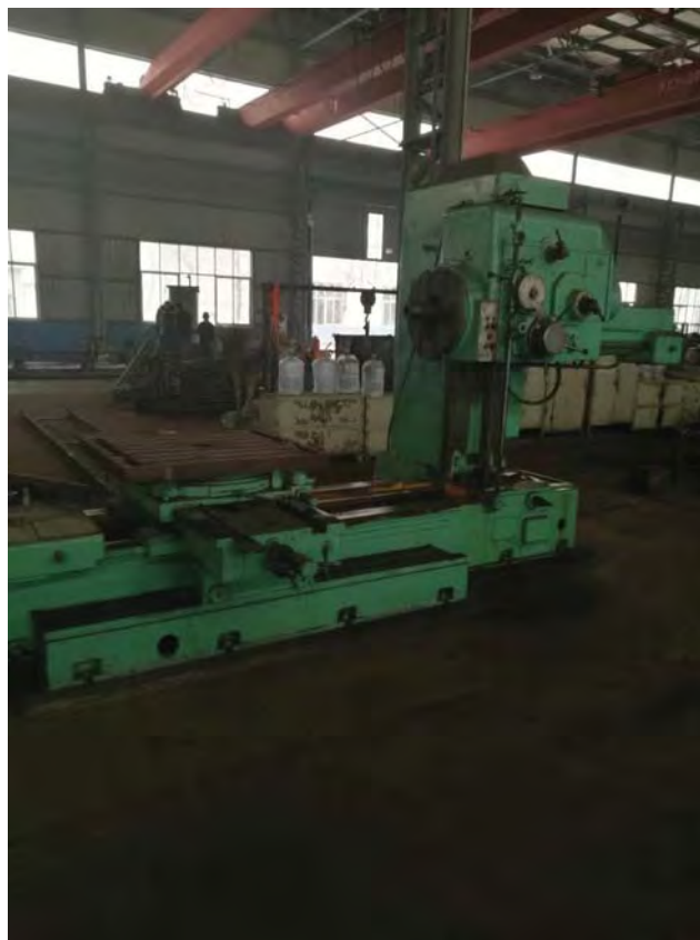
图 2-22 减速壳体工艺的镗主轴数控镗铣床 图 2-23 减速壳体工艺的孔端面、钻孔端面螺纹孔镗床
