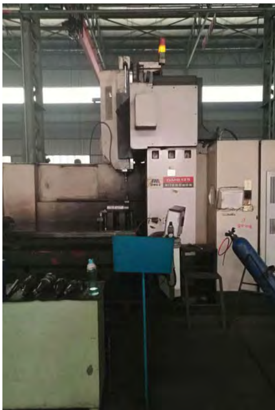
图 2-22 减速壳体工艺的镗主轴数控镗铣床 图 2-23 减速壳体工艺的孔端面、钻孔端面螺纹孔镗床
