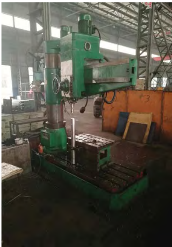
图 2-16 抽油杆接箍工艺的挤切螺纹钻床
