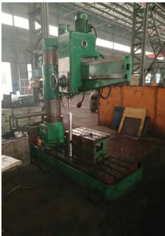
图 2-20 减速壳体工艺的合箱钻孔钻床
