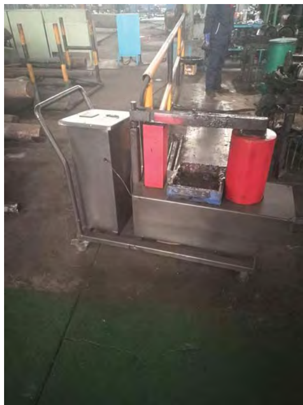
图 2-26 减速机齿轮及齿轮轴工艺的插键槽（插床）图 2-27 减速机装配工艺的（全自动轴承加热器）
