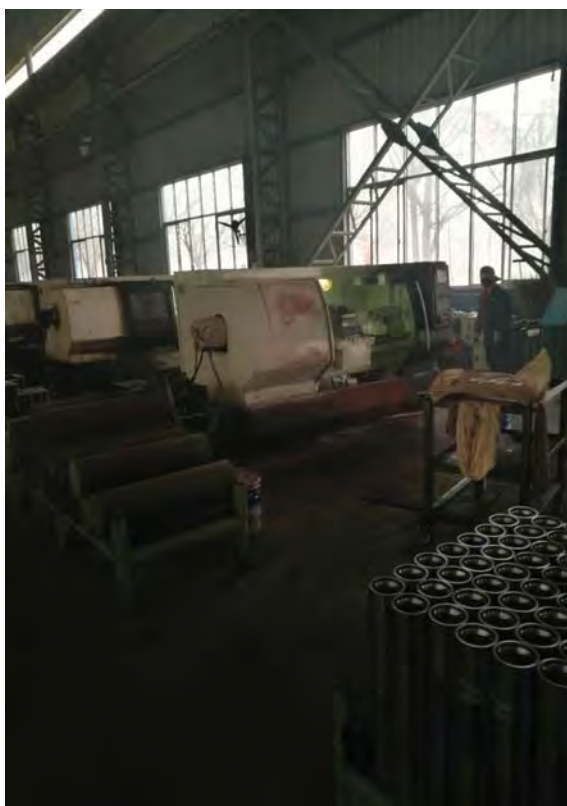
图 2-24 减速机齿轮及齿轮轴工艺的数控车床 图 2-25 减速机齿轮及齿轮轴工艺滚齿成型（滚齿机）
