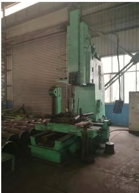
图 2-26 减速机齿轮及齿轮轴工艺的插键槽（插床）图 2-27 减速机装配工艺的（全自动轴承加热器）
