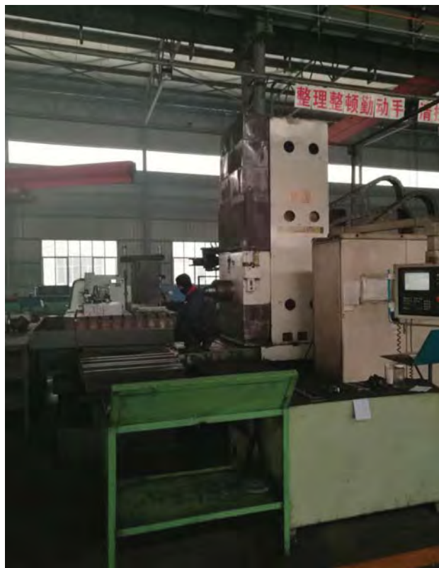
图 2-21 减速壳体工艺的镗三主轴孔（卧式加工中心）
